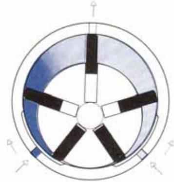
Kuva 34. Lamellimoottorin toimintaperiaate (Festo)
