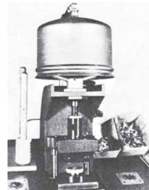
Niittaus yksitoimisella painerasialla
