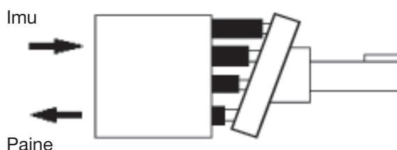
Kuva 10. Aksiaalimäntäpumpun periaate. Männät nojaavat liukulevyyn ja liukulevy on tietyssä kulmassa akseliin nähden. Kulman avulla aikaansaadaan mäntien edestakainen liike.
